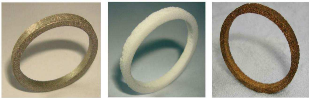
Figura 13 - Exemplos de elementos filtrantes (adaptado de Schnaid, 2009).
