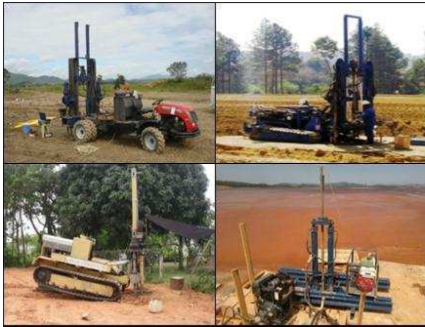
Figura 04 – Exemplos de perfuração do cone (adaptado de Schnaid et al. , 2009).
