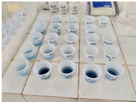
Figura 54 - Amostras com ácido ascórbico e molibdato de amônio para desenvolver cor.
