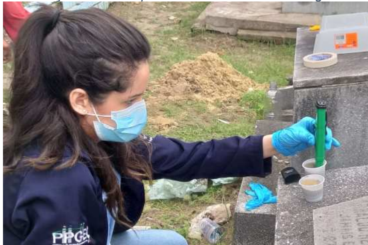
Figura 60 - Medição in loco de pH e ORP das amostras de água do cemitério.
