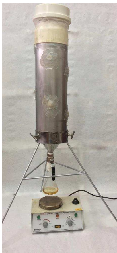
Figura 7. Adaptação do protótipo da célula de diafragma de Stokes para determinação do coeficiente de difusão do eugenol em arroz com casca
