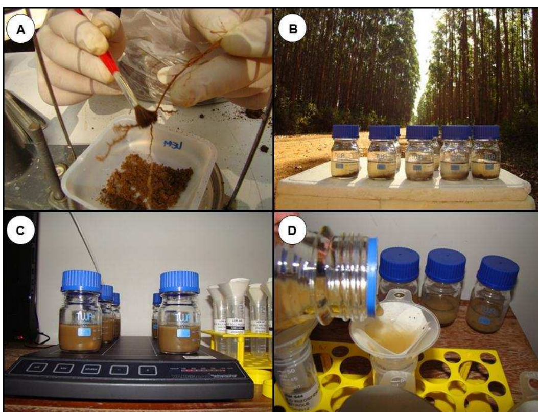
Figura 5: Preparo em campo do extrato para determinação dos teores de amônio e nitrato no solo. A - Remoção do solo rizosférico. B – Adição da solução extratora (KCl 1,0 mol L -1 ). C – Agitação contínua por 30 minutos. D – Filtração do extrato em papel de filtro quantitativo.
