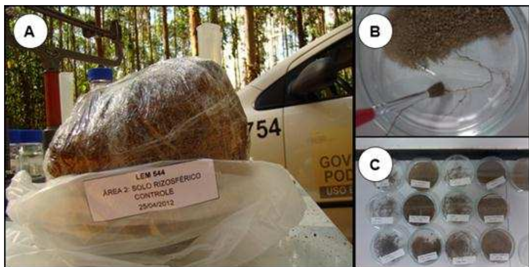
Figura 4: A - Bloco de solo embalado e identificado para transporte em caixa com gelo moído para posterior remoção do solo rizosférico. B e C – Remoção do solo rizosférico em laboratório.
