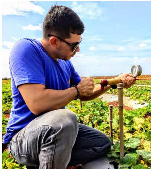
Figura 2.9. Coleta da solução do solo com auxílio dos extratores providos de cápsulas porosas.
