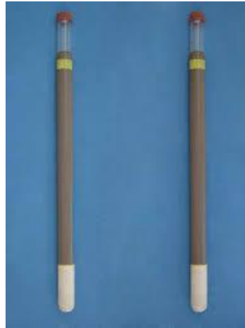
Figura 1.6. Detalhes dos tensiômetros de cápsula cerâmica, que foram instalados nos experimentos.
