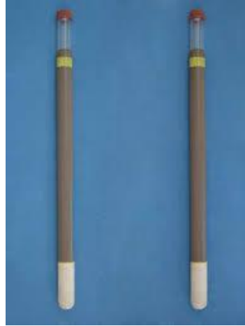
Figura 2.6. Detalhes dos tensiômetros de cápsula cerâmica que foram instalados nos experimentos.
