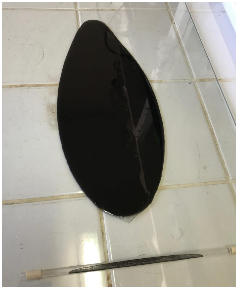
Figura A7. Solução filmogênica de acetato de celulose e biocarvão aplicada sobre vidro, em processo de secagem da acetona.
