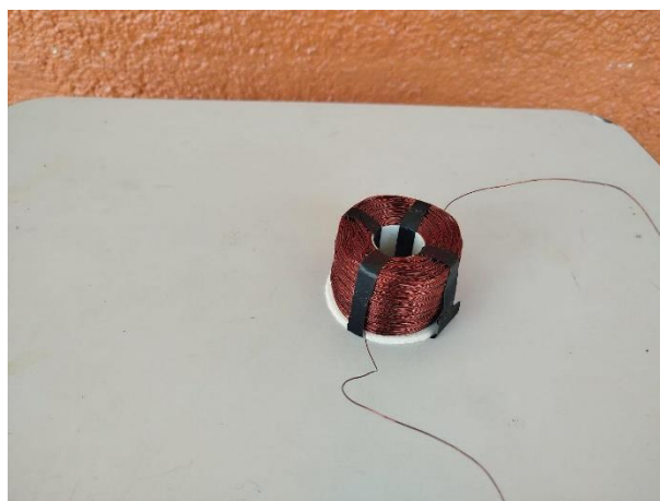
Figura 7 – Bobina de cobre feita com suporte fabricado na impressora 3D. Fonte: o autor
