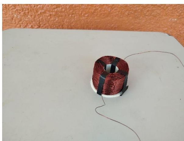
Figura 9 – Bobina de cobre feita com suporte fabricado na impressora 3D. Fonte: o autor
