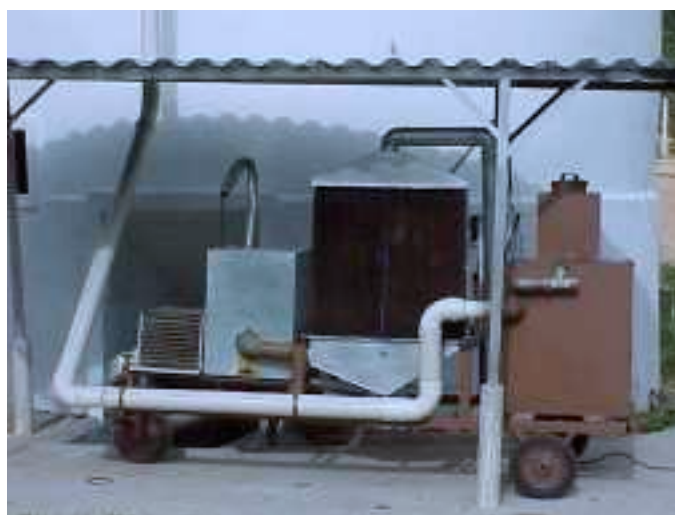
Figura 5 - Equipamento Gerador de CO 2 desenvolvido para realização do experimento.
