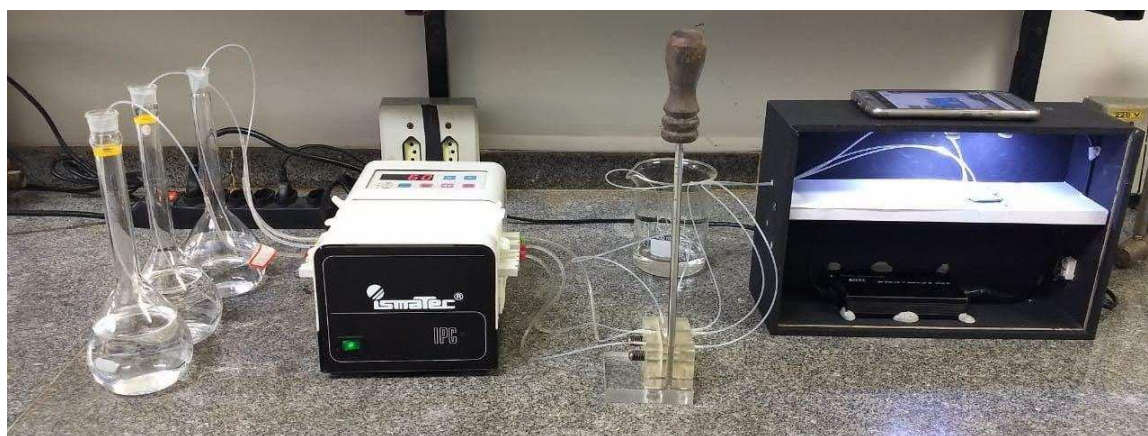
Figura 20- Sistema FIA utilizado neste trabalho. As soluções de interesse, bomba peristáltica, injetor de acrílico, caixa preta, bateria, LED, microdispositivo de LTCC e béquer para descarte.
