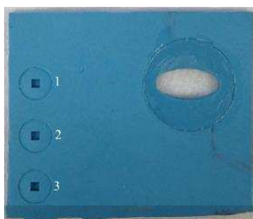
Figura 18- Dispositivo de análise construído com LTCC.
