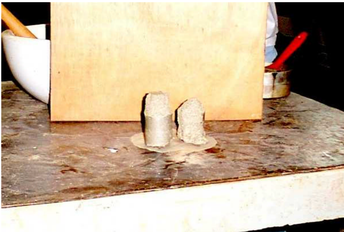
Figura 29 – Corpos-de-prova desintegrados após o período de imersão em água – Mistura com o solo VS.
