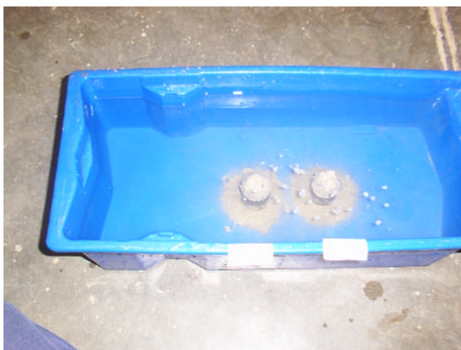
Figura 28 – Perda de massa do corpo-de-prova devido ao período de imersão em água (4º estágio)– Solo VS.
