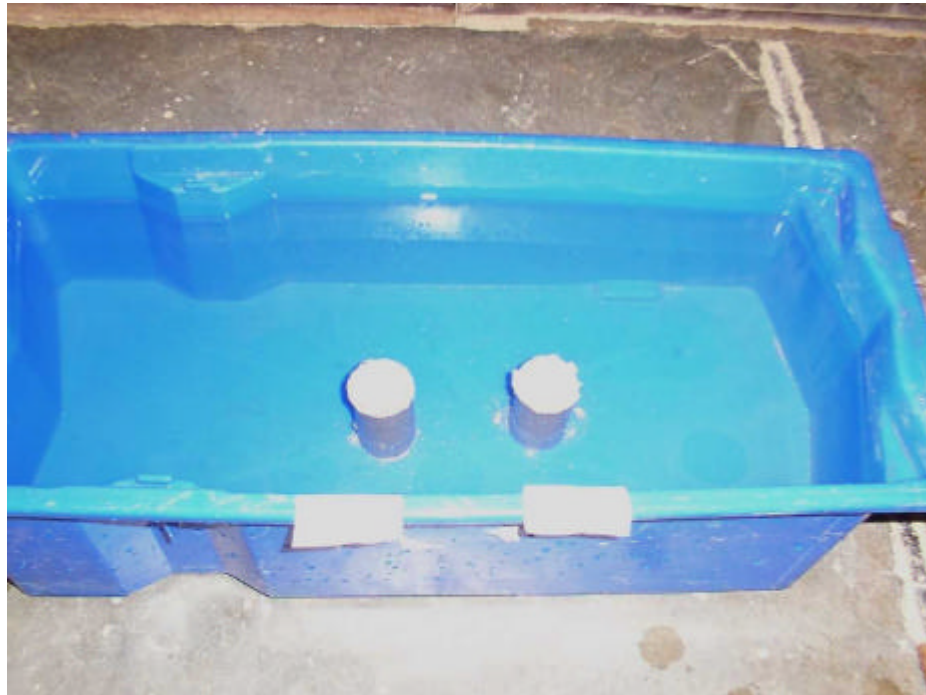
Figura 25 – Perda de massa do corpo-de-prova devido ao período de imersão em água (1º estágio) – Solo VS.
