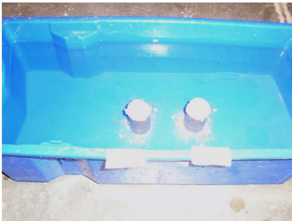
Figura 26 – Perda de massa do corpo-de-prova devido ao período de imersão em água (2º estágio) – Solo VS.
