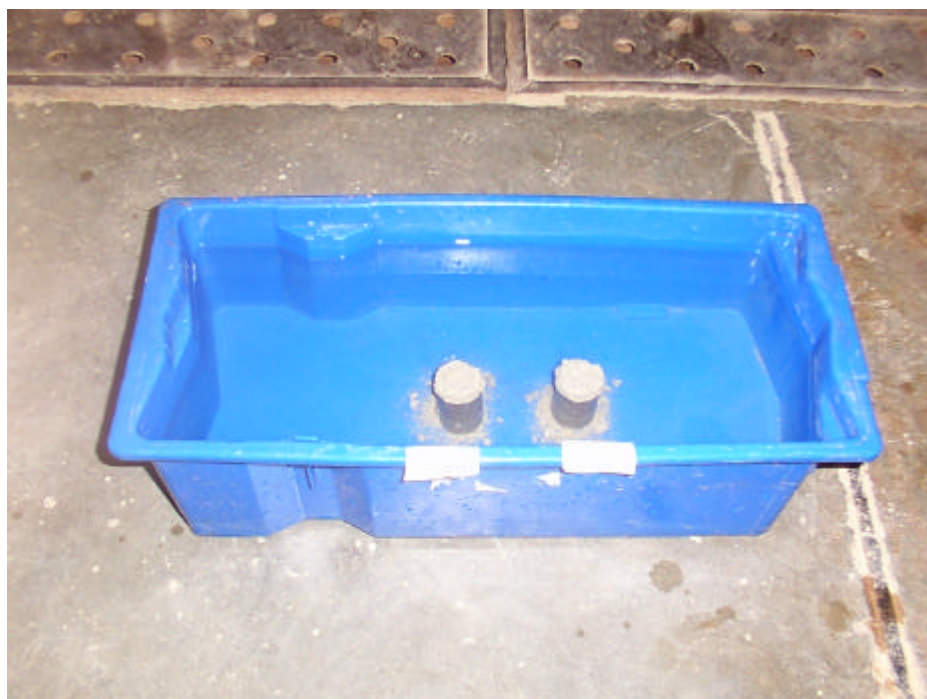
Figura 27 – Perda de massa do corpo-de-prova devido ao período de imersão em água (3º estágio)– Solo VS.
