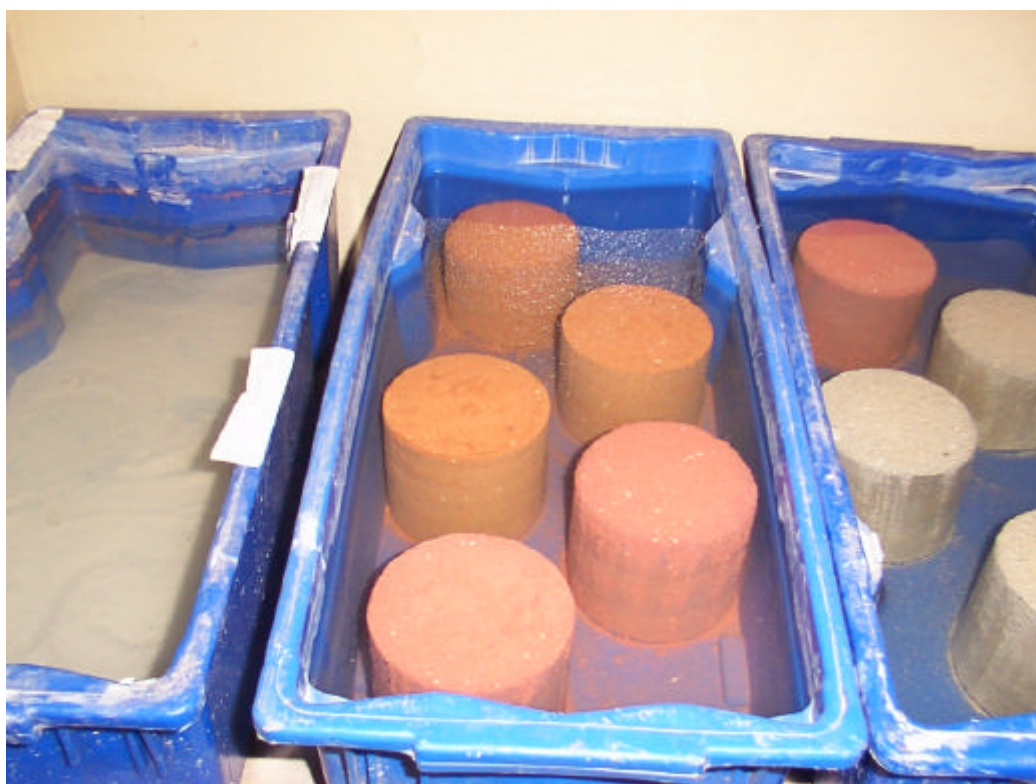
Figura 30 – Corpos-de-prova imersos em água durante o ensaio de durabilidade por molhagem e secagem.
