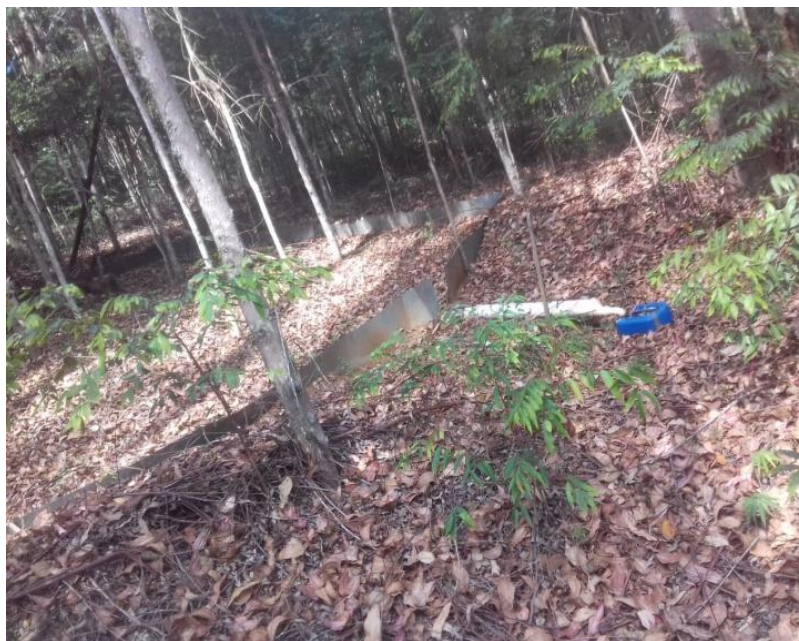
Figura 4 - Coleta escoamento superficial
