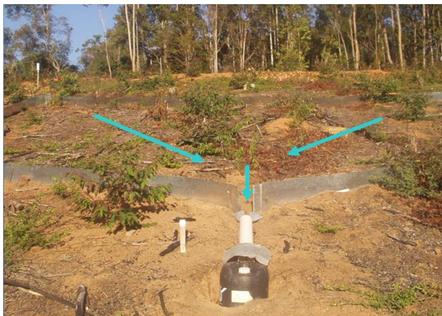
Figura 1 - Coleta de escoamento superficial na parcela de 60m 2
