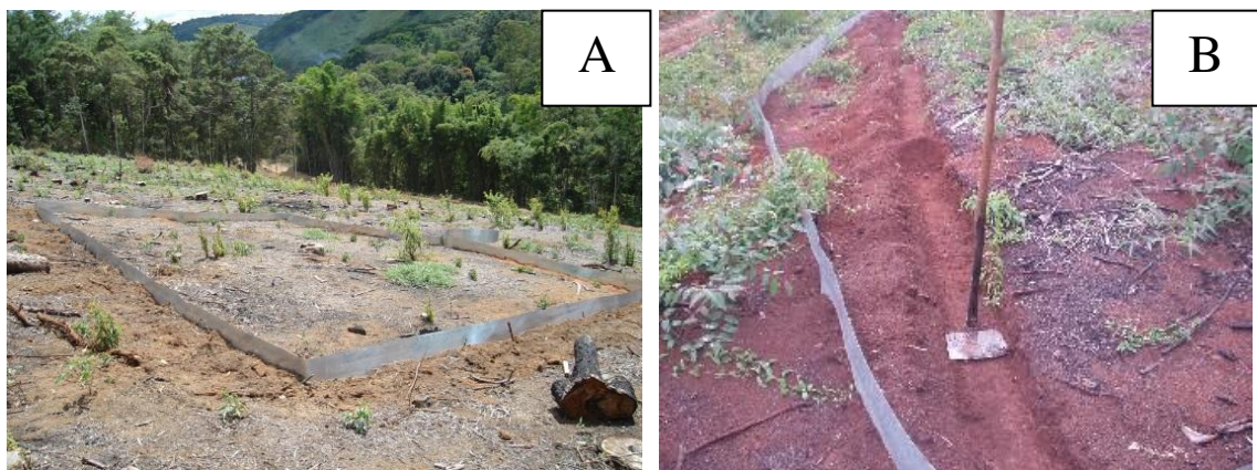
Figura 2 – Parcelas do experimento. A) Parcela de medição do escoamento superficial; Terraço de base estreita.
