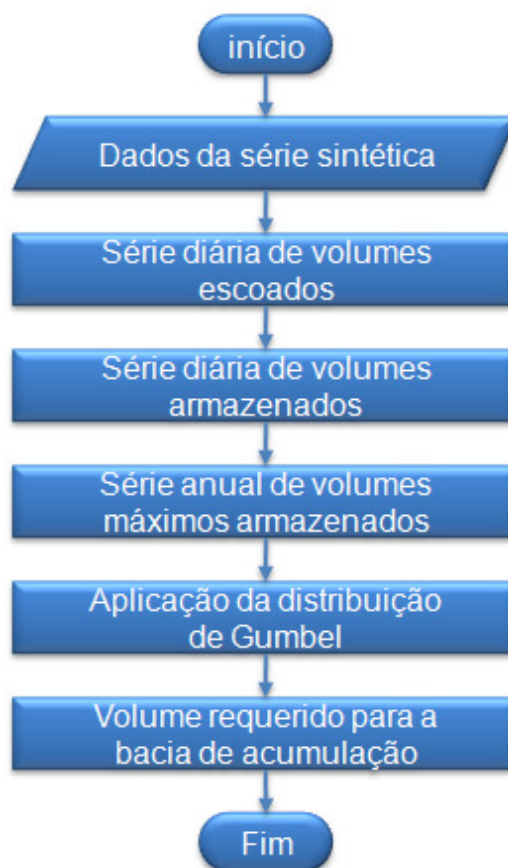
Figura 2 - Fluxograma simplificado da seqüência dos cálculos utilizados pelo modelo desenvolvido.
