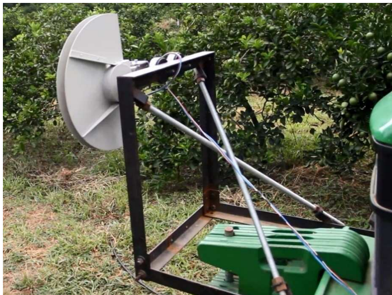
Figura 12 – Fixação do sensor Lidar no trator.
