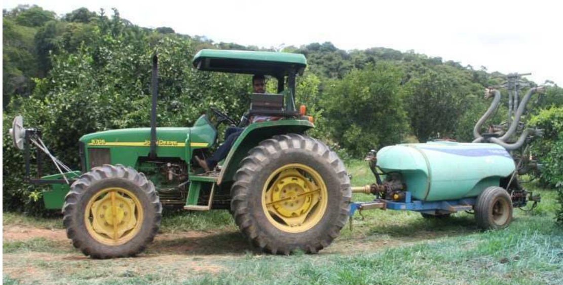
Figura 10 – Conjunto trator-pulverizador com o sistema de controle da pulverização.
