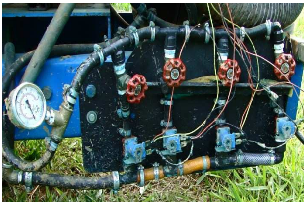
Figura 14 – Válvulas solenoides empregadas no controle da vazão do líquido.
