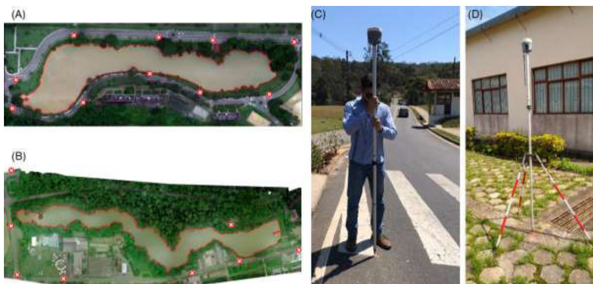
Figura 11 – Distribuição dos pontos de controle no reservatório 1 (A) e no reservatório 2 (B), demarcação dos pontos de controle em alvos já existentes no local (C) e base do GNSS RTK TPS T10 instalada (D).
