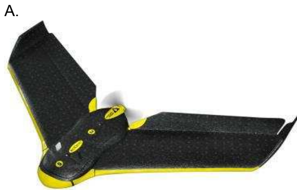
Figura 2 - Aeronave com asas fixas, eBee, desenvolvido pela empresa SenseFly (A) e com asas rotativas, Matrice 100 DJI, desenvolvido pela empresa DJI (B)
