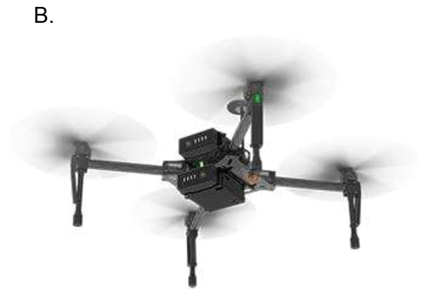
Figura 2 - Aeronave com asas fixas, eBee, desenvolvido pela empresa SenseFly (A) e com asas rotativas, Matrice 100 DJI, desenvolvido pela empresa DJI (B)
