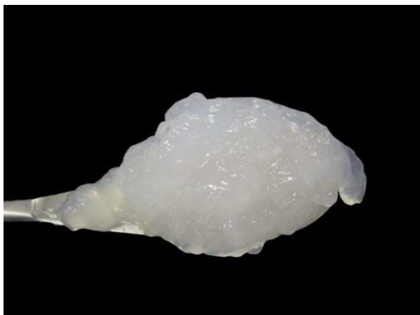
Figura 5 . Micrografia da CNF obtida por fibrilação mecânica aspecto visual do gel de CNF (adaptada de DUFRESNE, 2013).
