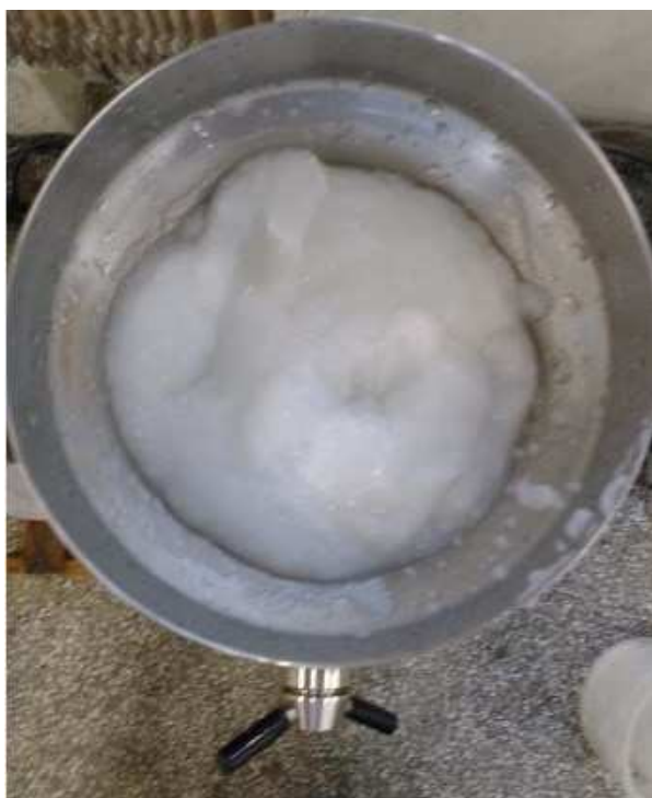
Figura 3- Celulose nanofibrilada a partir da polpa organossolve do bagaço de cana-de-açúcar branqueada (aspecto de gel)
