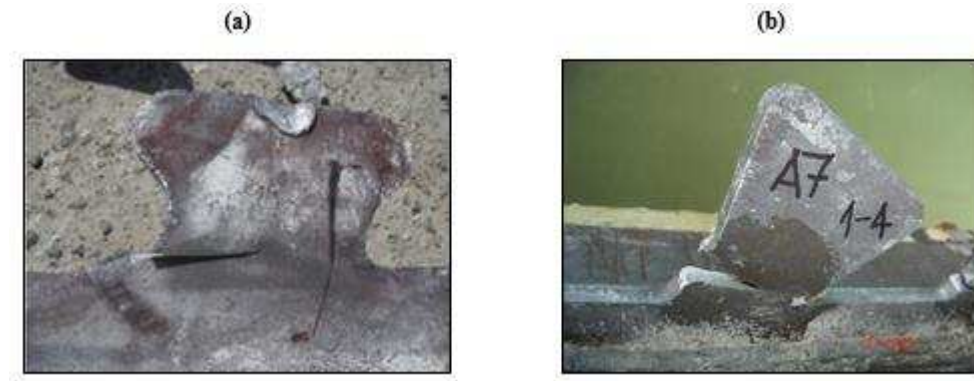
Figura 4. Falha do aço em conectores em chapa de aço recortada: (a) puzzle e (b) Crestbond.
