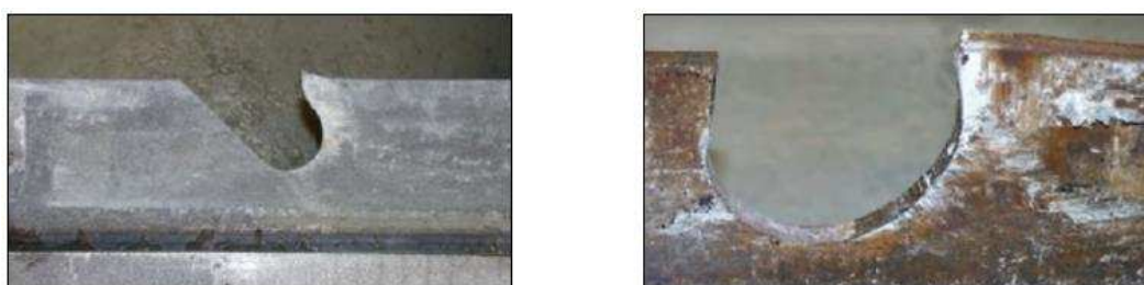
Figura 20. Chapa de conectores ensaiados por Zapfe (2001) deformada após ensaio push-out .
