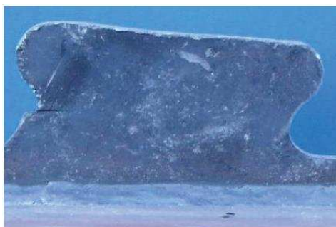
Figura 39. Falha do aço do conector puzzle .
