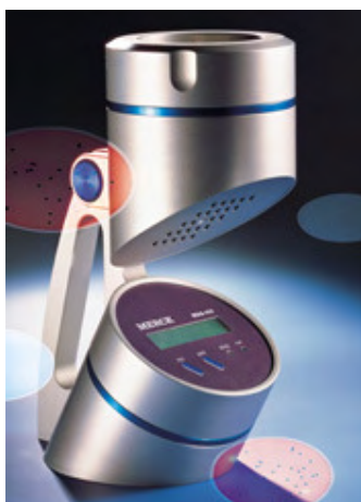
Figura 1 – Amostrador de ar por sucção. Fonte: MERCK, 2007.
