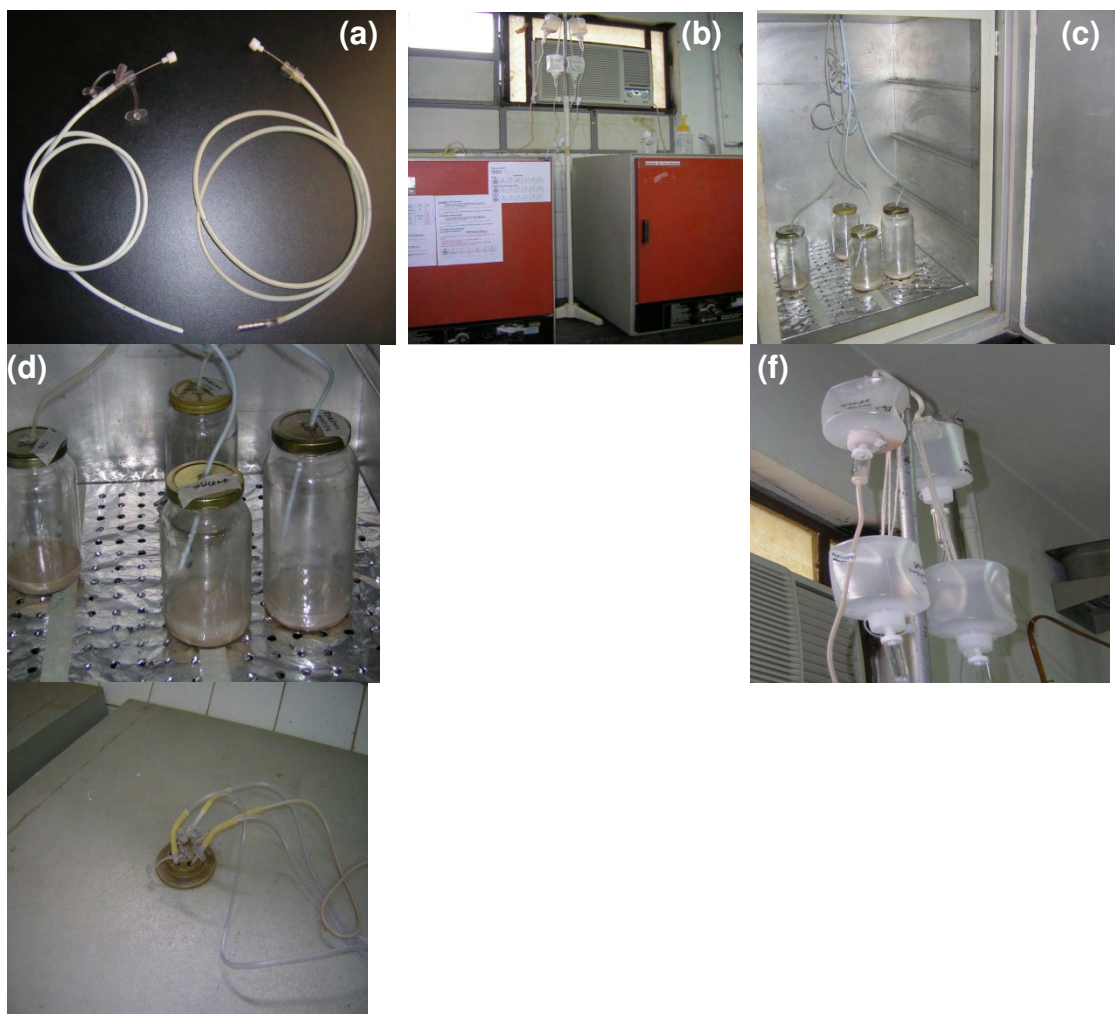
Figura 16 – Montagem do procedimento de administração da dieta em laboratório: (a) sondas nasoenterais de silicone (esquerda) e de poliuretano (direita), utilizadas no experimento; (b) estufa utilizada no experimento, com o suporte de dietas ao lado direito; (c) os frascos de vidro utilizados como recipientes coletores; (d) frascos coletores; (e) frascos de armazenamento de dieta; e (f) vista superior da estufa, onde se realizou a conexão sonda-equipeo.
