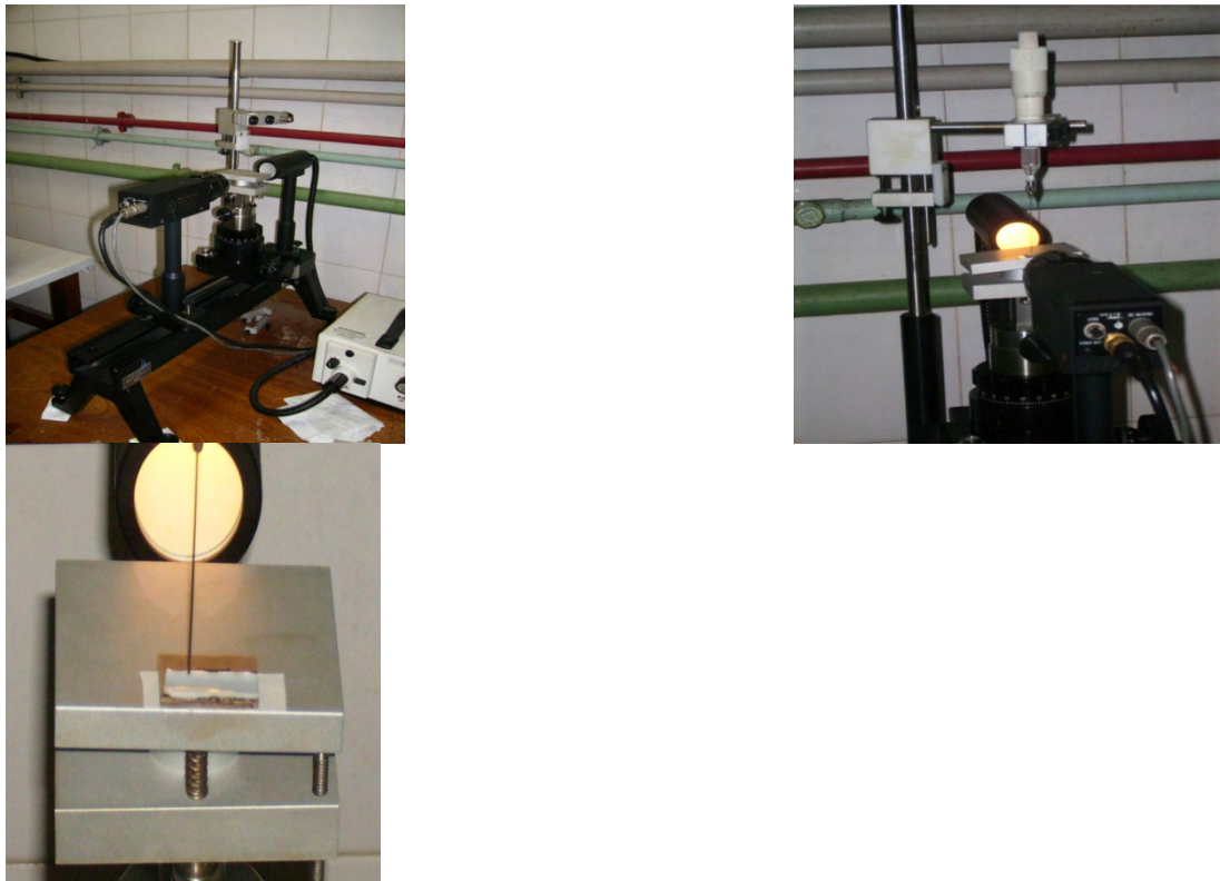
Figura 15 – Goniômetro: equipamento utilizado na medida do ângulo de contato entre as sondas e a água.
