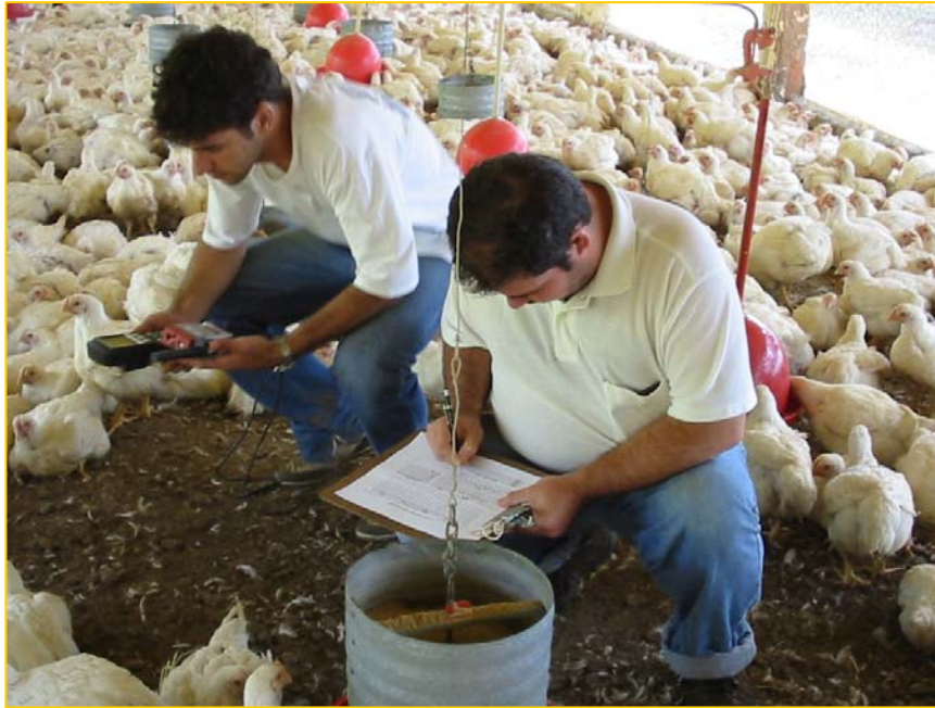
Figura 06: Coleta de dados para análise de gases (amônia e dióxido de carbono) no interior do galpão
