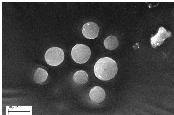
Figura 4.11: Imagem por microscopia eletrônica de varredura de um grupo de esferas sólidas de poliestireno produzidas a partir de dispositivo de microfluídica.
