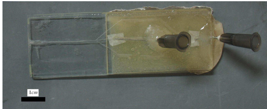
Figura 4.22: Dispositivo construído a partir da corrosão no vidro.
