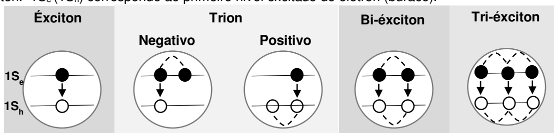
Figura 43: Esquema representativo dos estados éxciton, trion (negativo e positivo), bi-éxciton e tri-éxciton. 1S_e ( 1S_h ) corresponde ao primeiro nível excitado do elétron (buraco).
