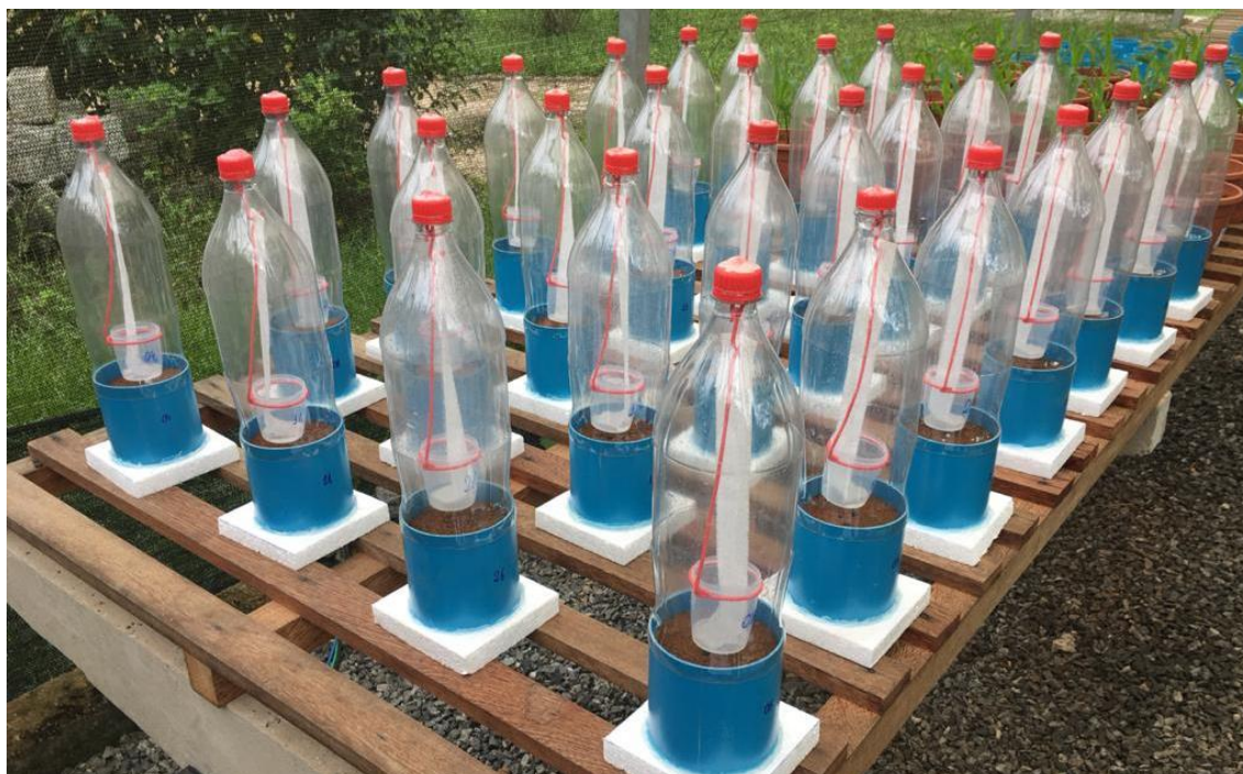
Figura 5.1. Câmara de quantificação de volatilização de amônia.
