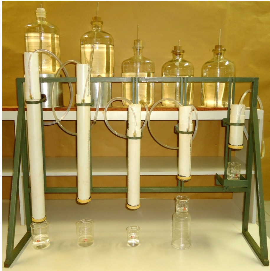
Figura 4 – Permeômetros com colunas de lixiviação de comprimentos iguais a 50, 40, 30, 20 e 10 cm.
