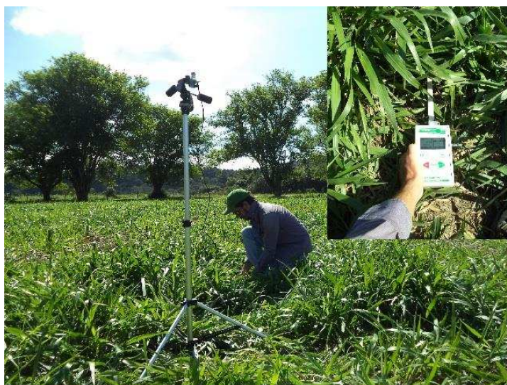
Figura 1.3 – Medição de interceptação luminosa.
