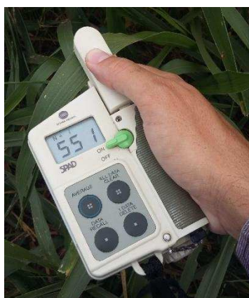
Figura 1.4 – Medição de clorofila com o equipamento SPAD.
