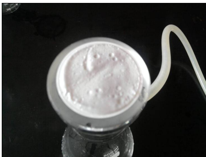
Figura 18 - Resíduo gerado após manipulação com ajuste de pH seguida de filtração para a amostra coleta em junho de 2011 no ponto de saída da ETE de uma indústria de cosméticos
