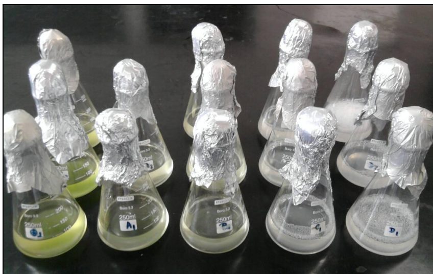
Figura 24 - Soluções-teste e controles* ao final de 72 horas de exposição a uma mistura 8% v/v dos principais surfactantes empregados no processo produtivo de uma indústria de cosméticos
