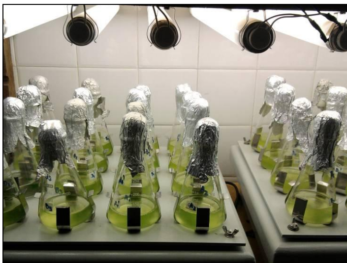
Figura 16 - Soluções-teste ao final de 72 horas de exposição às amostras provenientes da eluição com metanol das colunas C18 empregadas no processo de extração em fase sólida
