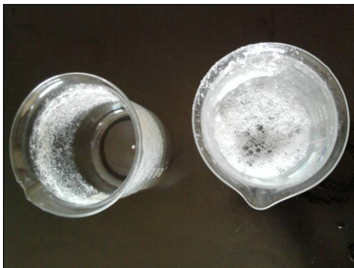
Figura 17 - Resíduo gerado após manipulação com ajuste de pH seguida de aeração para a amostra coleta em junho de 2011 no ponto de saída da ETE de uma indústria de cosméticos
