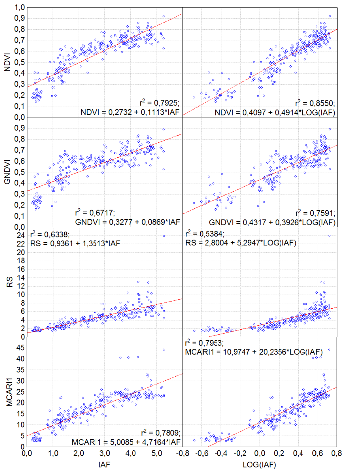
Figura 22. Modelos de regressão dos índices de vegetação em função do índice de área foliar e dos índices de vegetação em função do logarítmico do índice de área foliar, em imagem reflectância.
