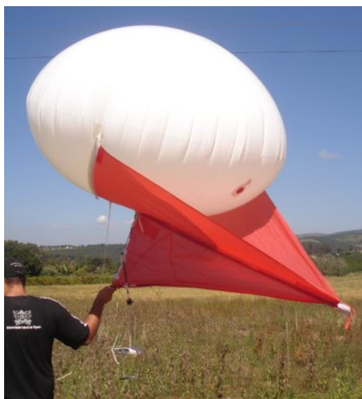
Figura 3. O balão, modelo SkyshotHelikite, utilizado para o sistema de sensoriamento remoto.
