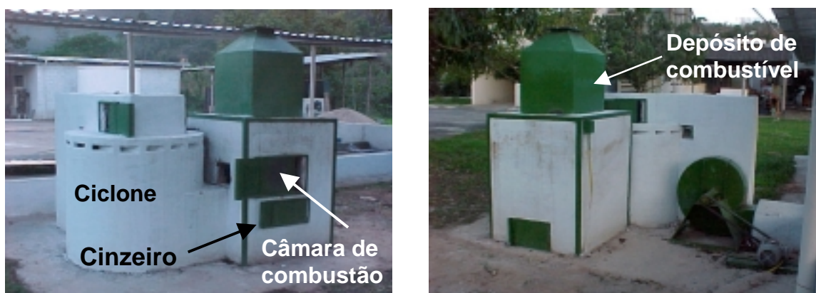
Figura 8 - Fornalha para aquecimento direto do ar (SILVA et al. 2000).
