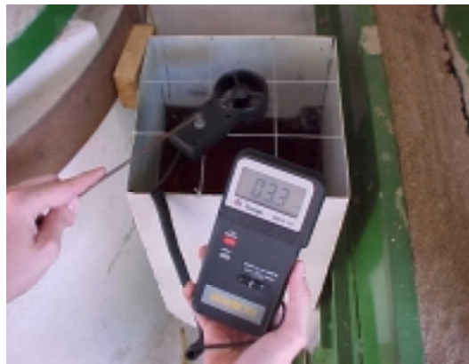
Figura 46 - Medição da velocidade do ar comburente na entrada da câmara de combustão.
