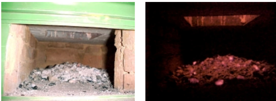
Figura 23 - Compartimento cinzeiro onde é mostrada abertura na laje da câmara de combustão por onde caem as cinzas.
