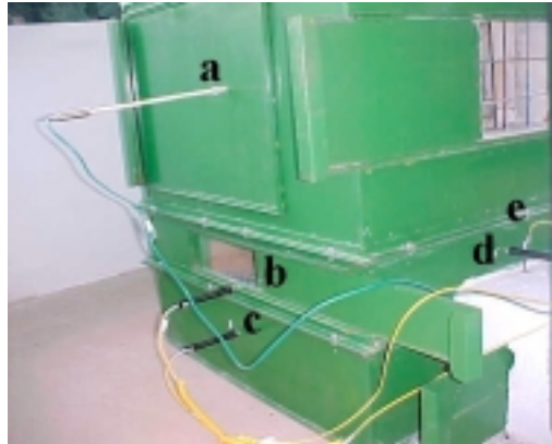
Figura 40 - Posicionamento das sondas de medição da temperatura. Na célula de queima (a); nas cinzas (b); na parede interna da base da fornalha (c); na parede interna do cinzeiro d; e dos gases na saída da fornalha (e).
