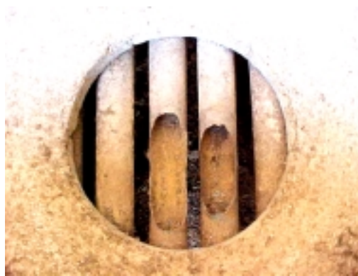
Figura 11 - Desgaste em uma grelha refrigerada a ar.
