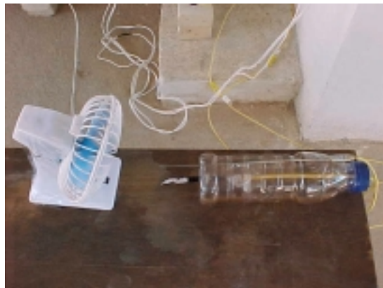
Figura 44 - Psicrômetro para medição da temperatura de bulbo molhado e de bulbo seco do ar ambiente.
