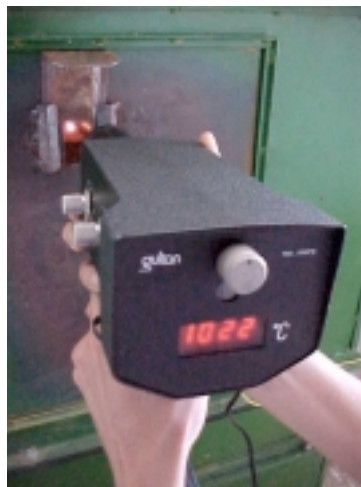
Figura 36 - Medição da temperatura da célula de queima utilizando-se o pirômetro.
