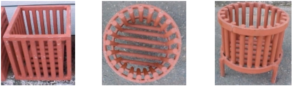
Figura 10 - Grelhas cúbica e cilíndrica para queima de combustível sólido (carvão vegetal).
