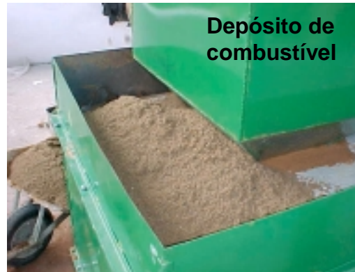
Figura 26 - Enchimento da caixa de areia e depósito de combustível.
