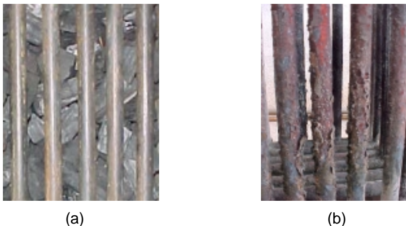
Figura 103 - (a) Grelha com pouco tempo de uso (nova). (b) Corrosão térmica verificada na célula de queima C3, após uso intensivo.
