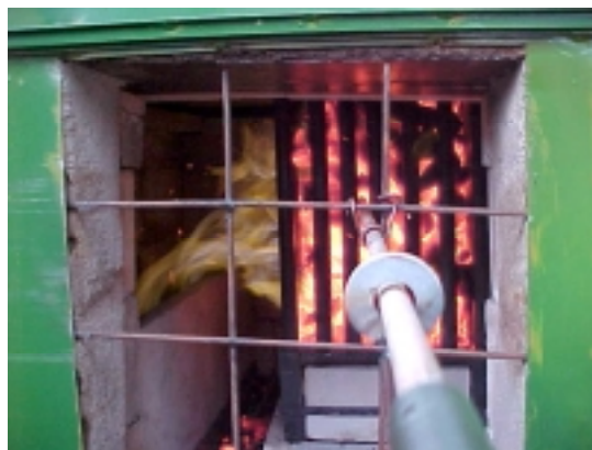
Figura 37 - Medição 27 da temperatura na célula de queima, com sonda termométrica tipo S.
