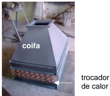
Figura 70 - Coifa para condução do ar quente do trocador de calor para o sistema de condução de ar para o ventilador.
