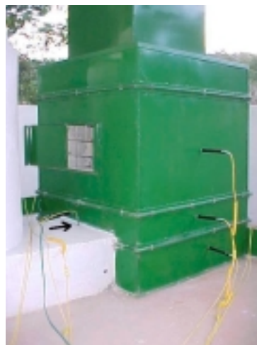
Figura 39 - Medição da temperatura dos gases na saída da fornalha.
