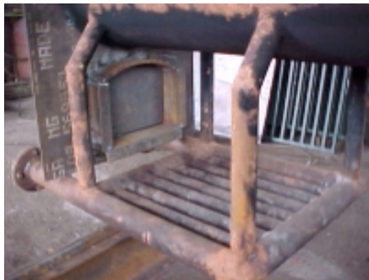
Figura 52 - Grelha “molhada” da fornalha interna, antes da montagem.
