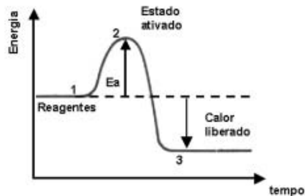
Figura 3 - Níveis de energia envolvidos numa reação exotérmica.
