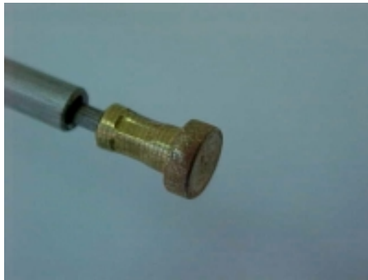
Figura 35 - Sensor de superfície com pastilha na junta quente.
