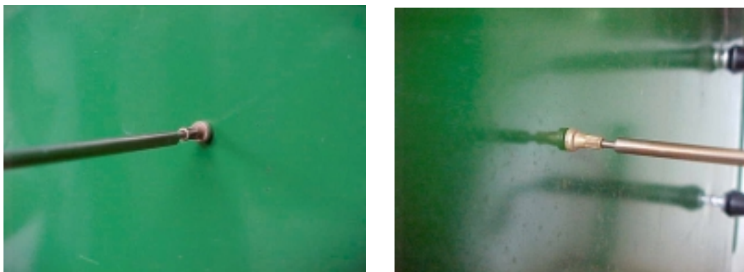
Figura 43 - Medição de temperatura na superfície externa da fornalha.
