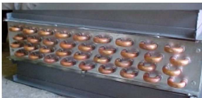
Figura 17 - Distribuição dos circuitos em um trocador de calor compacto, com 18 tubos na face, 4 fileiras e 8 passagens por circuito.
