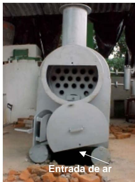
Figura 15 - Fornalha flamotubular em montagem, na qual se mostra os “tubos de fumaça”, a chaminé e a abertura para entrada de ar comburente.
