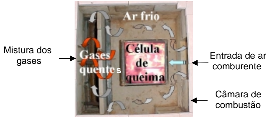
Figura 74 - Trajetória do ar comburente no interior da câmara de combustão e a mistura dele com os gases quentes resultantes da combustão.
