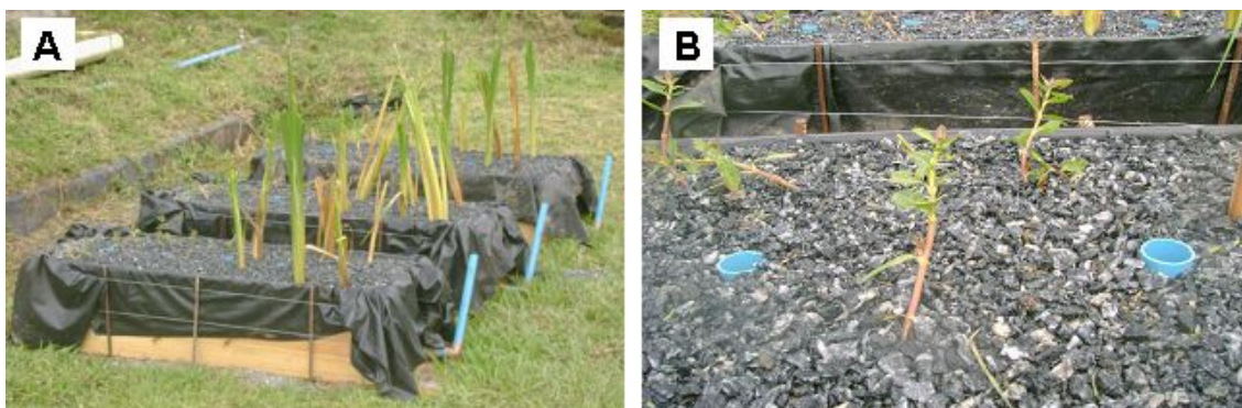
Figura 3.2. Vista geral dos SACESFs após o plantio da alternanthera e da taboa (A) e detalhe das mudas de alternanthera em crescimento no meio suporte (B).
