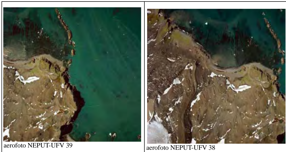
Figura 4.4 - Primeiro par aerofotográfico da segunda linha de vôo inserida (notar o recobrimento lateral com as fotos 44 e 46, da figura 4.3).
