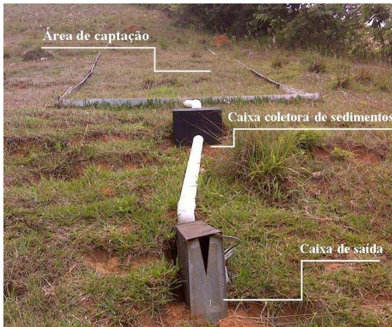
Figura 5. Registro fotográfico da estrutura da parcela experimental instalada em campo.
