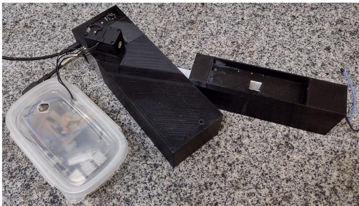
Figura 19. Foto do instrumento montado para análises de absorvância.
