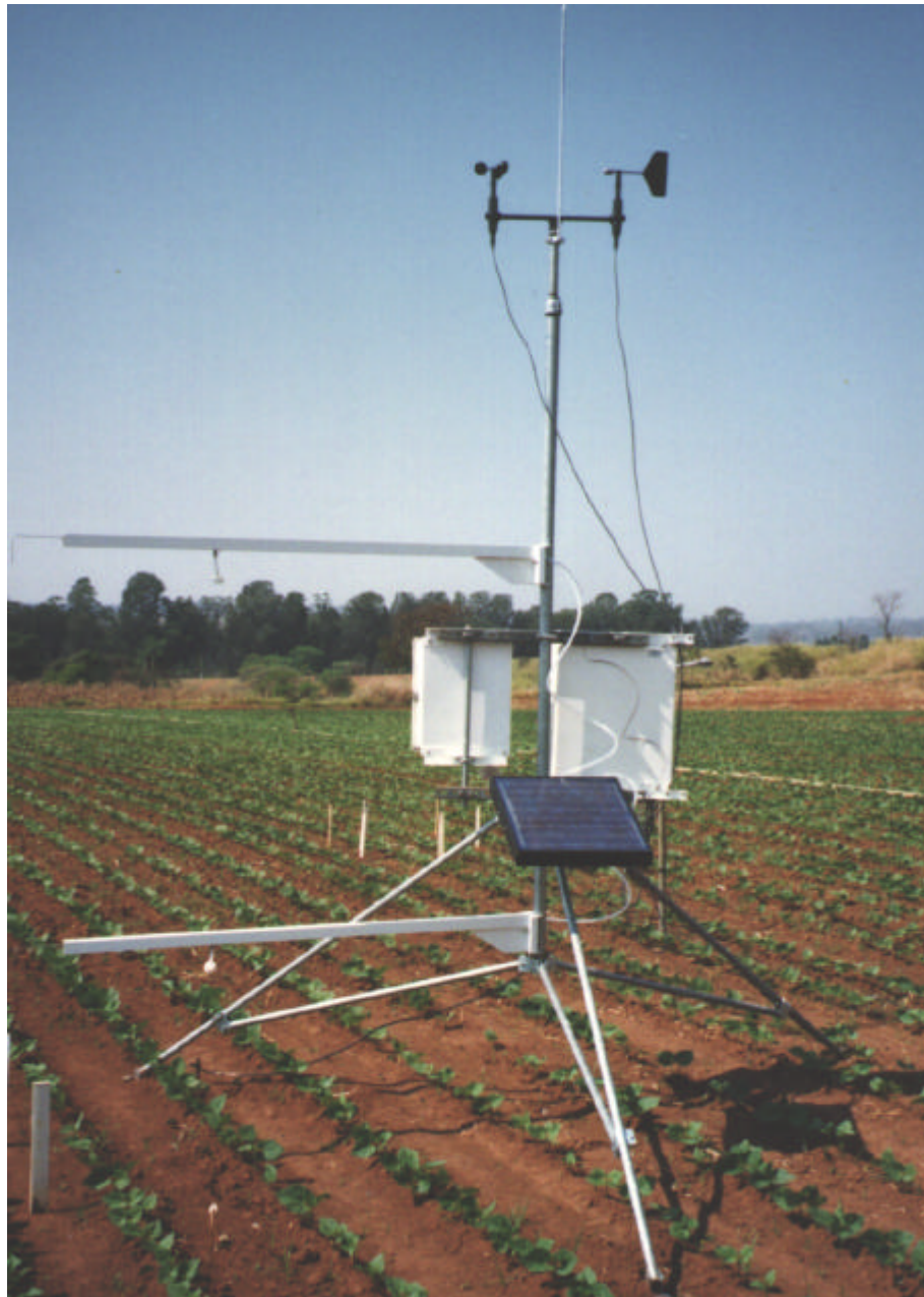
Figura 3. Sistema Razão de Bowen com sensores de temperatura do ar e pontos de aspiração do ar (pressão de vapor), velocidade e direção do vento, abrigos de proteção e painel solar. Embrapa Milho e Sorgo, Sete Lagoas, MG, 1998.
