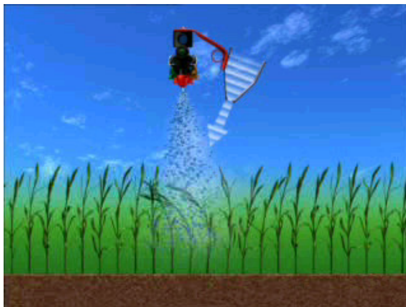
Figura 1 – Transporte da calda para o interior do dossel da cultura causado pela assistência de ar.
