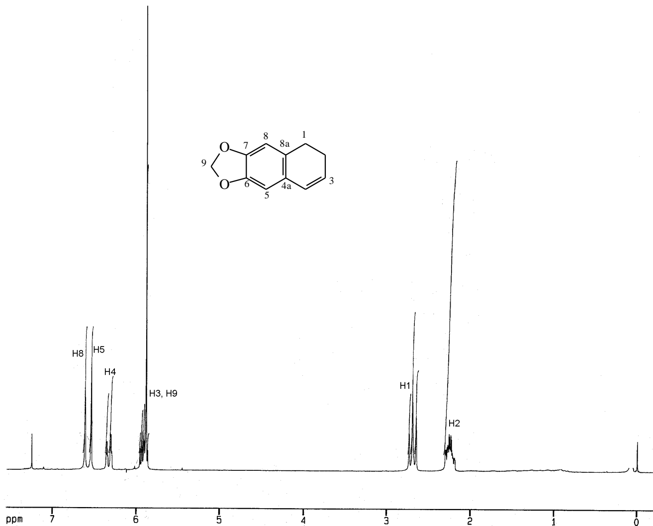
Figura 19 - Espectro de RMN de ^1\text{H} (200 MHz, \text{CDCl}_3 ) do 1,2-diidro-6,7-metilenodioxinaftaleno [7].
