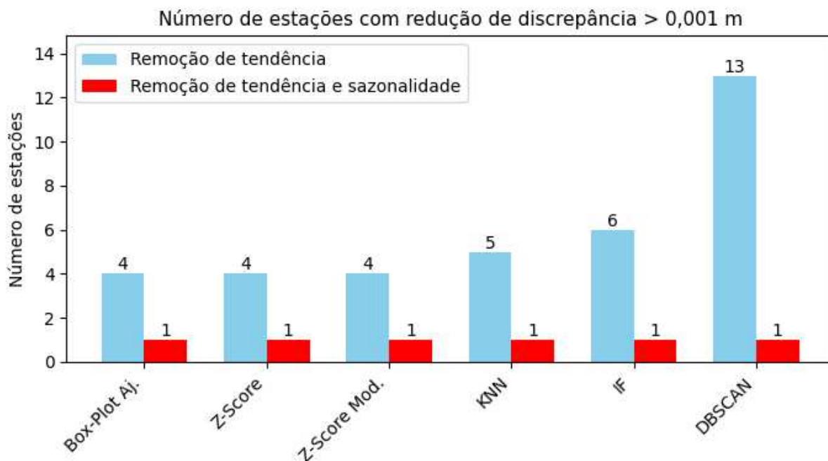
Figura 59 - Comparação do número de estações com redução de discrepância maior que 0,001 m após a remoção de outliers em séries sem tendência e sem tendência e sazonalidade.
