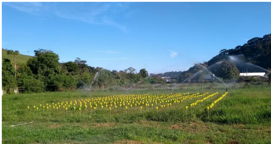
Figura 6. Avaliação da lâmina de irrigação e uniformidade de distribuição de água.
