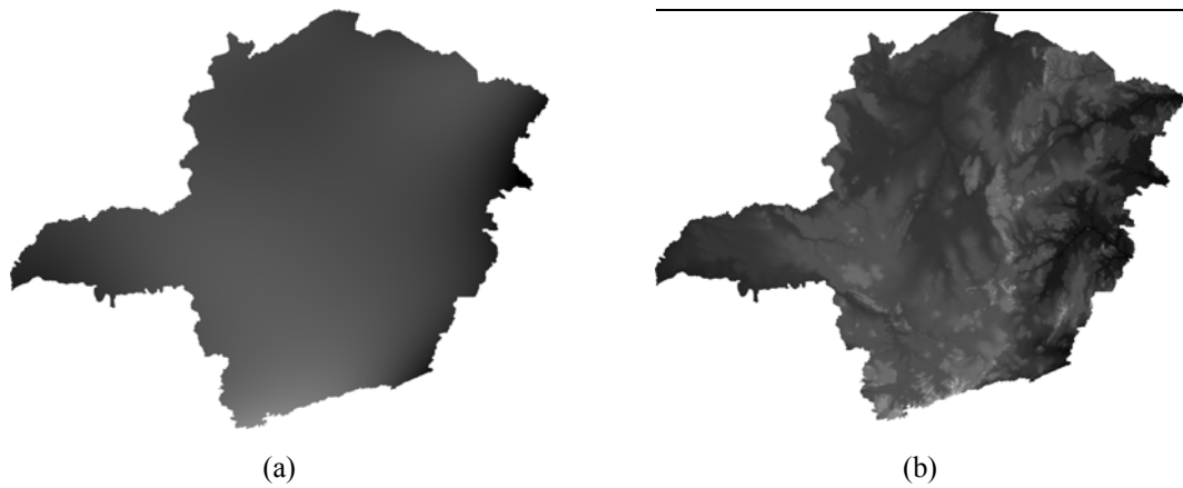
Figura 4.16. (a) Imagem gerada a partir do polinômio de grau 5 em x e em y. (b) Imagem gerada a partir do MDE de Minas Gerais
