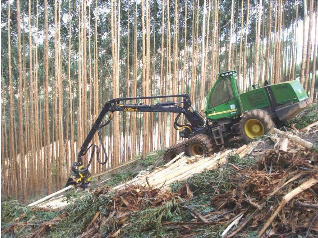
Figura 3 – Harvester John Deere, modelo 1270D realizando a operação de descascamento e remoção de galhos.
