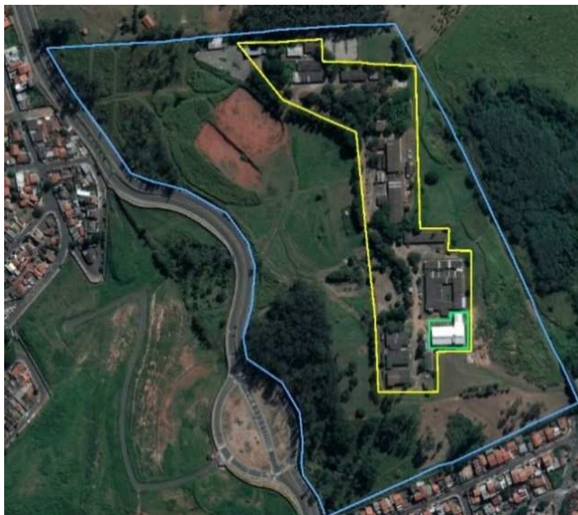
Figura 23 – Recomendação do PANGEIA/ABIN de garantir três níveis de barreiras de proteção (Azul, amarelo e verde) em instalação NB-3 brasileira mm .
