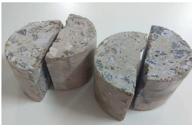
Figura 9 - Plano de corte dos corpos de prova.
