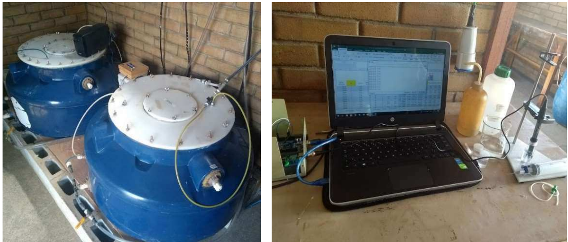
Figura 8 - Câmaras de carbonatação e instrumentos para medição da concentração de CO 2 .
