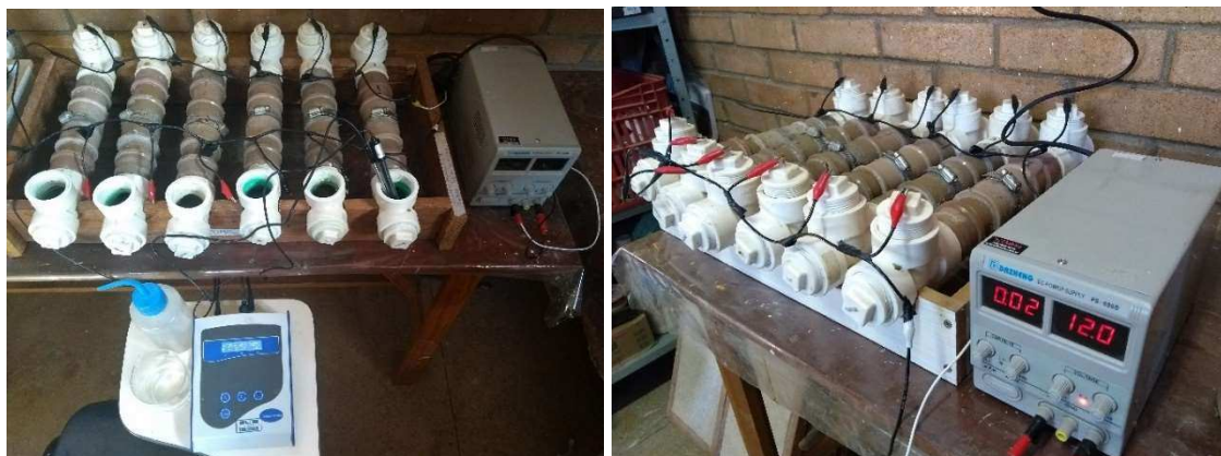
Figura 17 - Ensaio de migração de íons cloretos (LMC/UFV).
