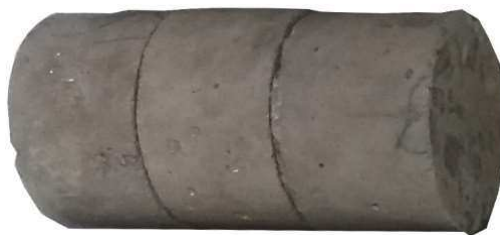
Figura 2 - Preparação de amostra para ensaio de carbonatação acelerada.
