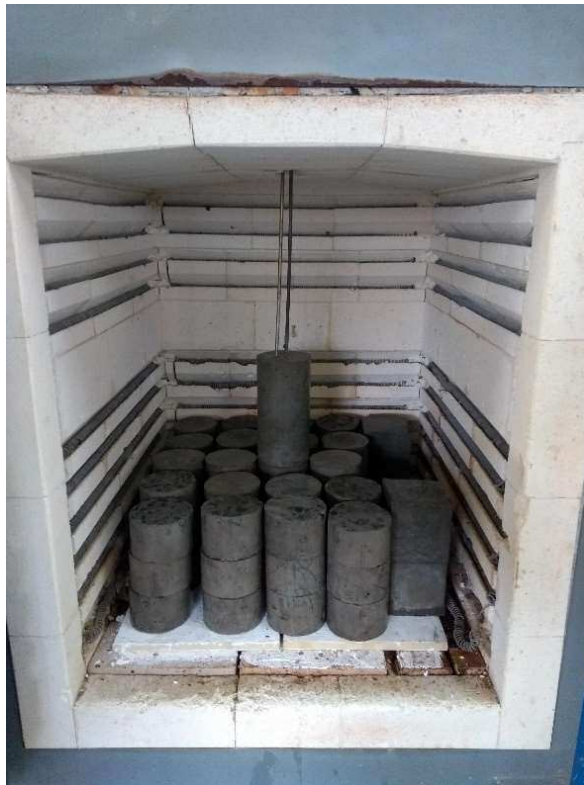
Figura 3 - Posicionamento dos CP's para aquecimento no forno mufla
