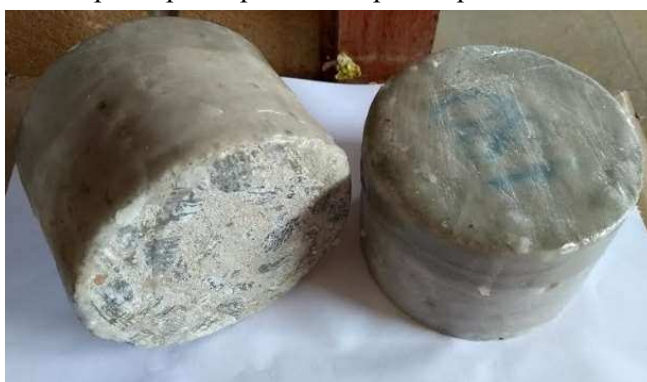
Figura 6 - Corpo de prova parafinado pronto para entrada na câmara.
