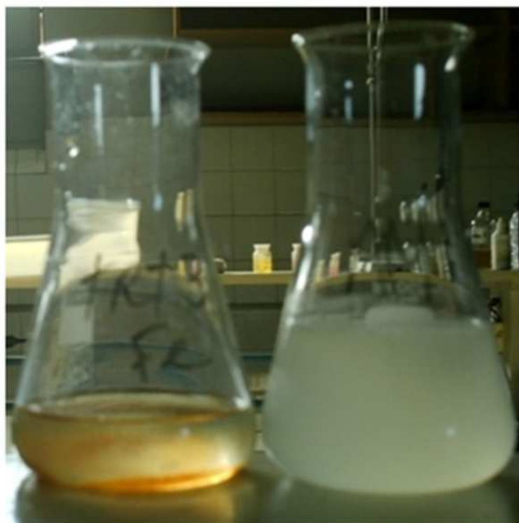
Figura 3 – Aspecto do efluente após tratamento por EC (a esquerda) e efluente bruto (a direita).
