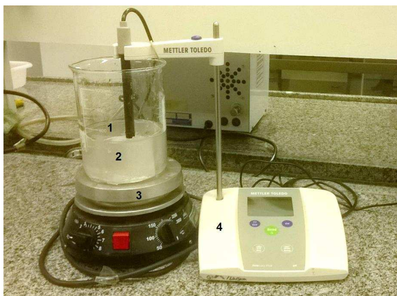
Figura 5: Montagem do sistema reacional para a degradação da parationa metílica da água utilizando a placa de Al(vz). (1) solução aquosa do agrotóxico 1 mg/L; (2) placa de Al(vz); (3) agitador magnético; (4) pHmetro.
