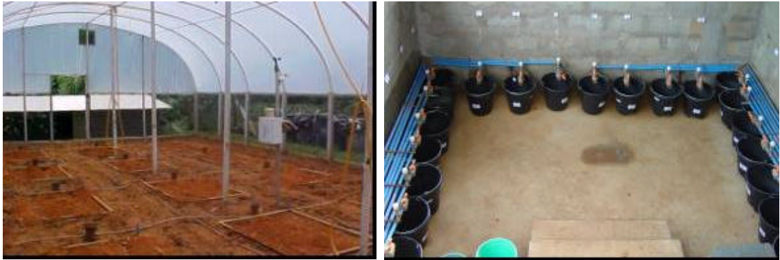
Figura 1 – Visão geral da área experimental, mostrando, à esquerda, os lisímetros e a estação agrometeorológica automática e, à direita, a estação de coleta de efluente sob ambiente protegido.
