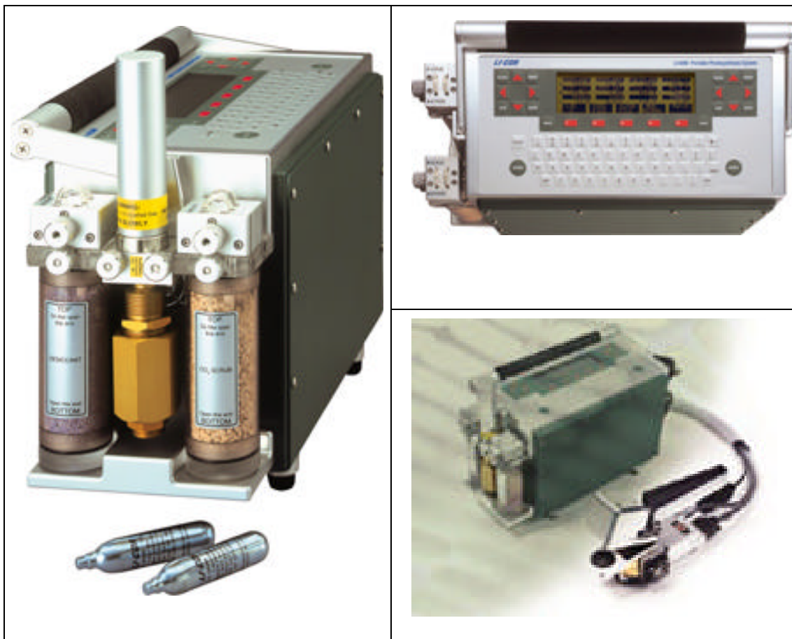
Figura 2.1 – Detalhes do analisador de gases no infravermelho portátil, utilizado para medir as taxas fotossintéticas, a transpiração e a condutância estomática das folhas.
