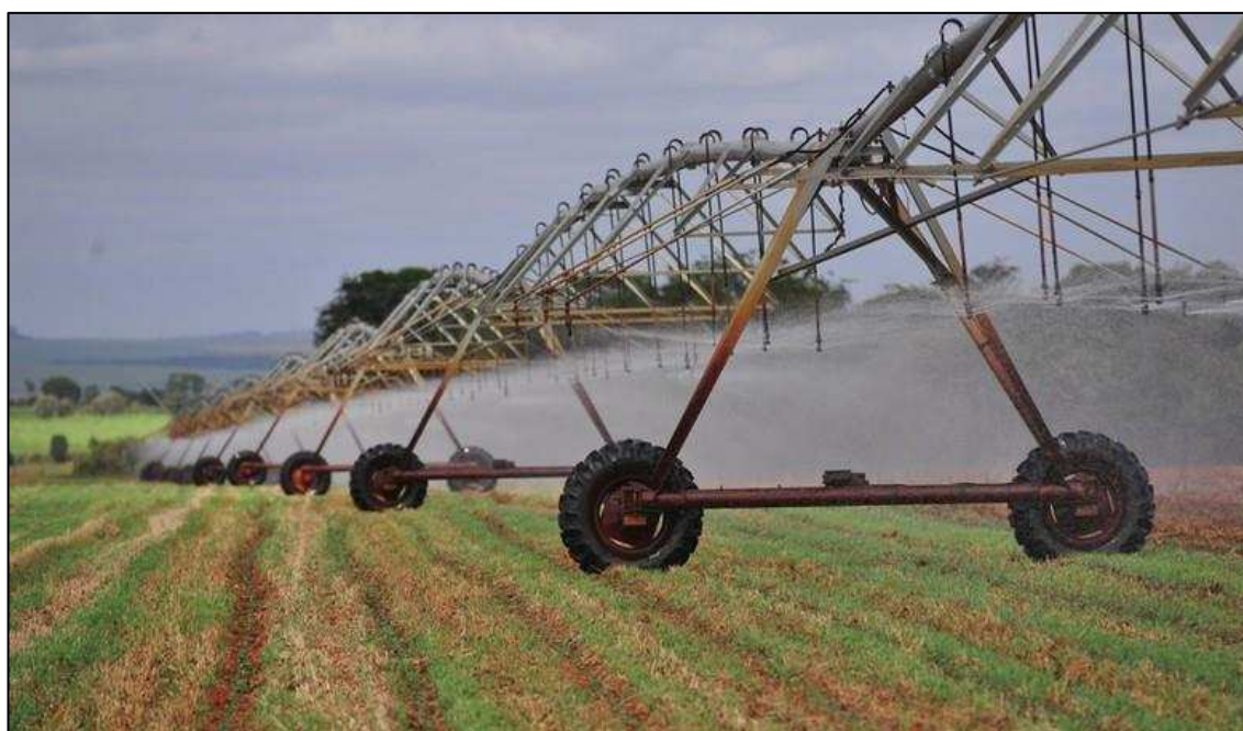
Figura 1: Modelo de estrutura do sistema de irrigação por pivô central. Fonte: Irrigação (2015).
