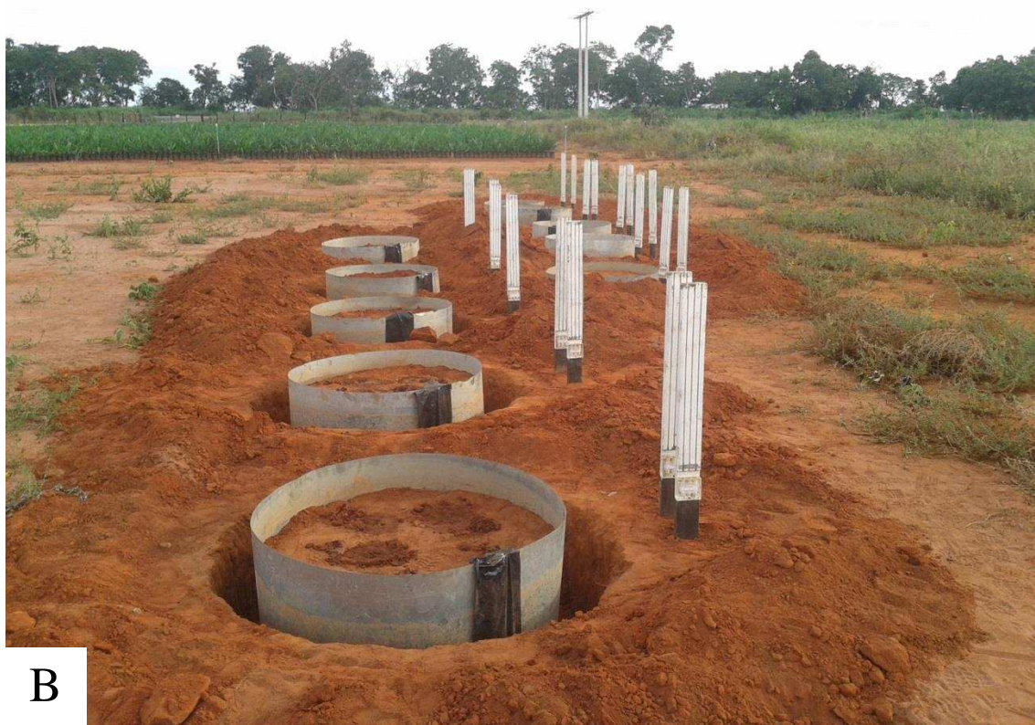
Figura A.17 - Estruturas cilíndricas de chapa galvanizada instaladas nas áreas experimentais 1 (A) e 2 (B).
