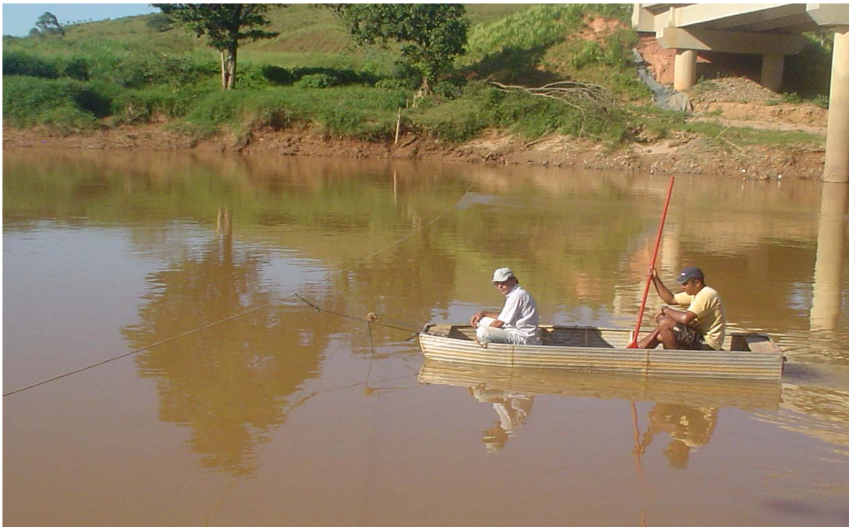
Figura 21. Medição de vazão no Rio Pomba, a jusante da cidade de Cataguases - MG
