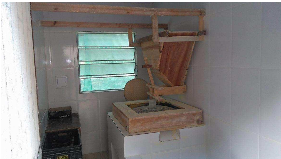
Figura 2 – Moinho movido a motor construído por um agricultor de Paula Cândido.
