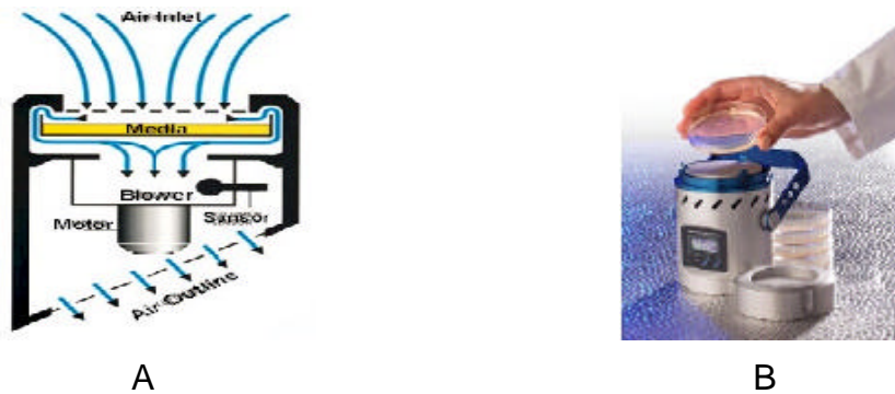
Figura 1 – Esquema e princípio de funcionamento de um amostrador de ar (A) e foto do equipamento Air sampler MAS – 100 (B) (Merck ® , 2005).
