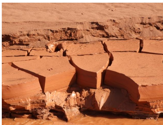
Fotografia 2. Rejeito em processo de secagem para posterior revegetação; em destaque a característica maciça do material.
