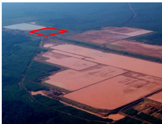
Fotografia 4. Área de mineração e disposição do rejeito da lavagem de bauxita. A área em destaque refere-se à de estudo (tanque SP1).
