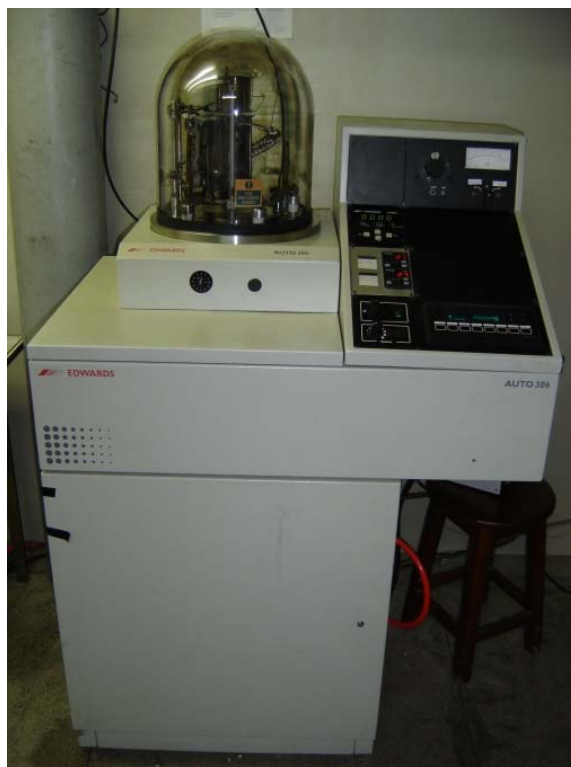
Figura 20 - Fotografia da evaporadora EDWARDS AUTO306.
